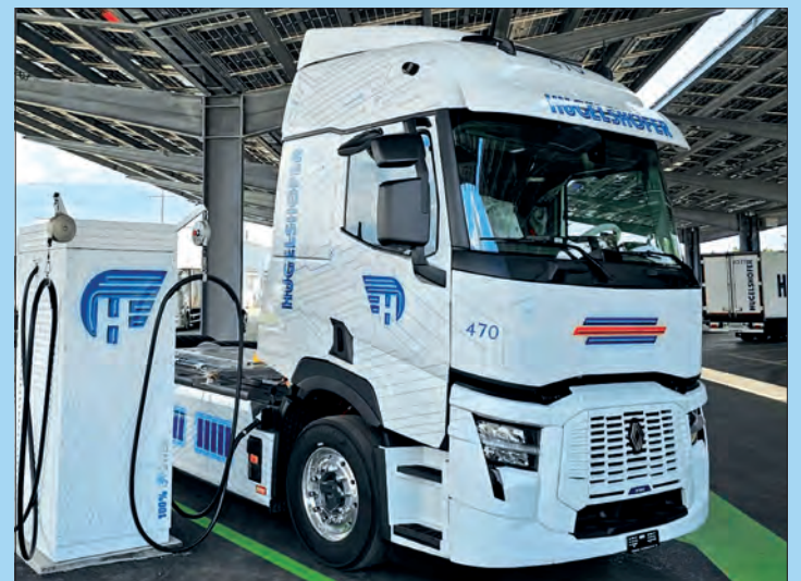
Les camions électriques présentent un surpoids de 4 à 6 tonnes - batteries obligent - par rapport à leurs équivalents thermiques.
